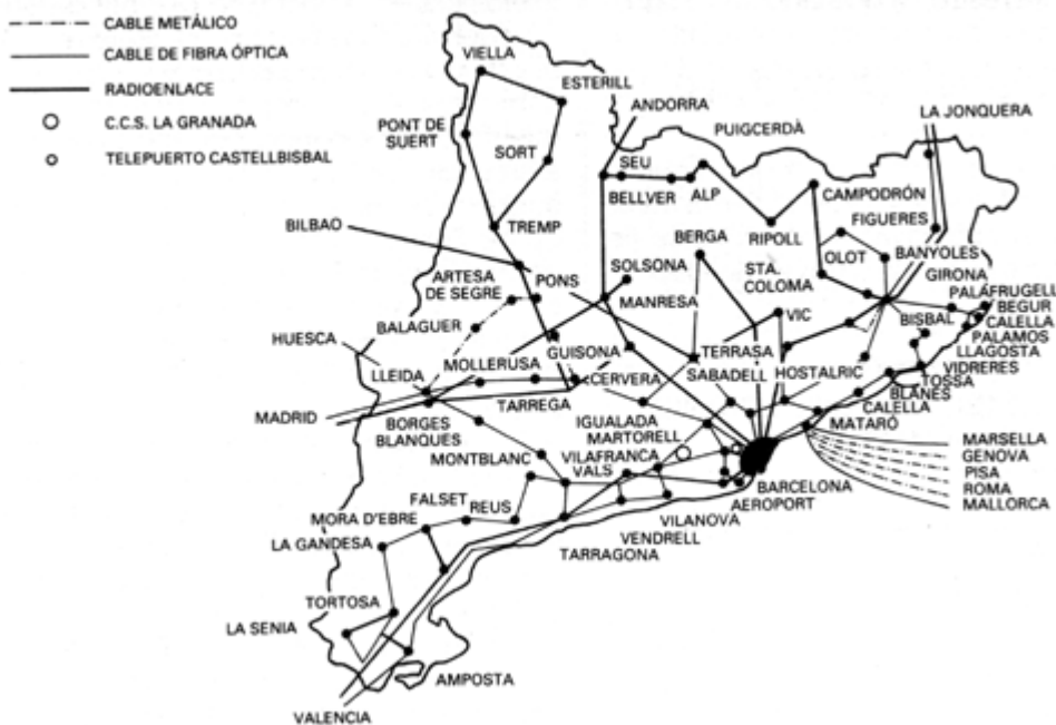
Figura 2. Infraestructura de la red de transportes
