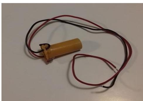
Figura 5. Interruptor de nivel para el circuito eléctrico
